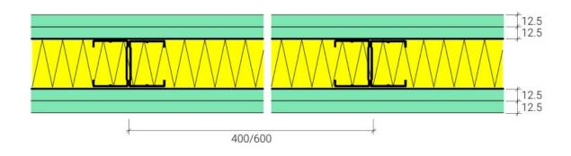
A solução Drywall - 100 é adequada para aplicações em divisórias interiores com desempenho regular, o gesso laminado é um material regulador de humidade com qualidades térmicas e acústicas óptimas. A utilização de placas GYPFOR AQUA com bordo afinado (BA), é indicada para ambientes com presença de humidade. Solução com isolante acústico no espaço interior e boa performance acústica.
